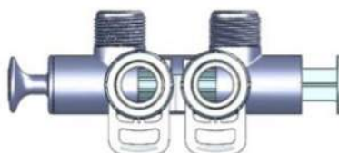
L'eau ne traverse pas la vanne.
