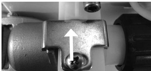
4. Placer la clame de fixation du dessus. Placer la pointe de la clame dans la loge du bloc by-pass prévu à cet effet. Visser la vis taraudeuse pour maintenir. Mettre la deuxième clame de fixation et visser la vis. Visser à fond les deux vis taraudeuses.
