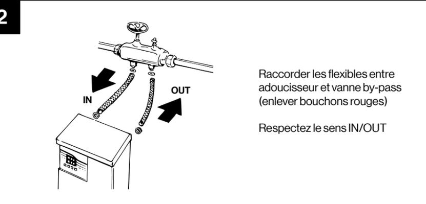
Raccorder les flexibles entre adoucisseur et vanne by-pass (enlever bouchons rouges)
