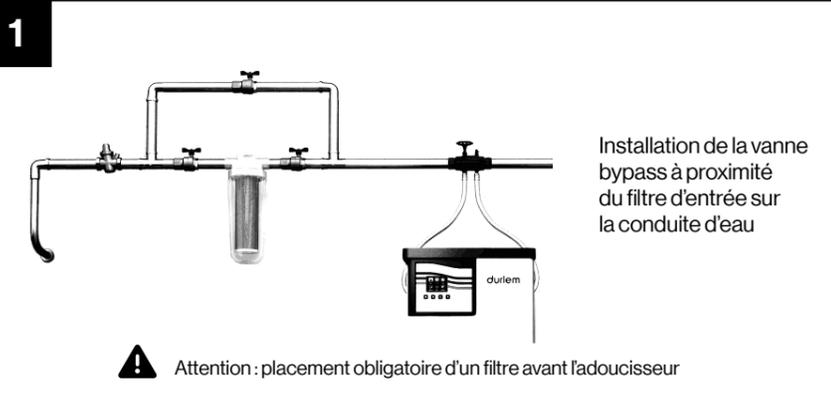
Installation de la vanne bypass à proximité du filtre d'entrée sur la conduite d'eau
